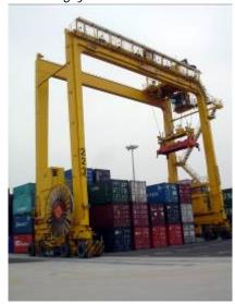
BU: Die Lösung mit Motorleitungstrommeln kann eine geeignete Alternative bei der Elektrifizierung von RTGs sein
