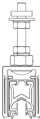
Abb. 61: Schiene ist in Schienenhalter eingeklippt
