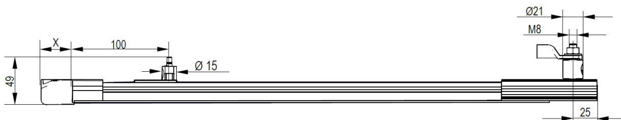
Abb. 45: Abstand von Schienenkante bis zur stationären Antenne
