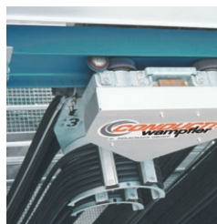
Angetriebener Großleitungswagen mit Magnetschalter zur landseitigen Endabschaltung
